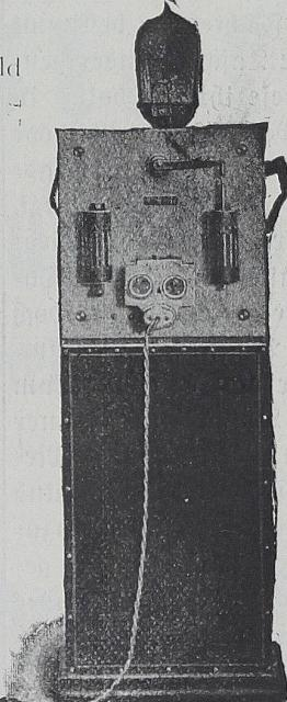
Der Quecksilberdampf-Gleichrichter Cooper Hewitt dient dazu, Wechselstrom in Gleichstrom umzuformen. Kostspielige Bedienung u. Unterhalt wie bei den rotierenden Umformern fallen dahin!
