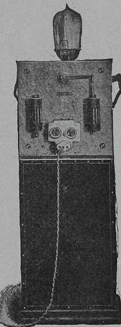
Der Quecksilberdampf-Gleichrichter Cooper Hewitt dient dazu, Wechselstrom in Gleichstrom umzuformen. Kostspielige Bedienung u. Unterhalt wie bei den rotierenden Umformern fallen dahin!
