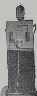
Der Quecksilberdampf-Gleichrichter Cooper Hewitt dient dazu, Wechselstrom in Gleichstrom umzuformen. spielige Bedienung u. Unterhalt wie bei den rotierenden Umformern fallen dahin!
