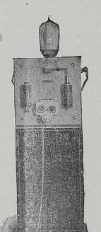
Der Quecksilberdampf-Gleichrichter Cooper Hewitt dient dazu, Wechselstrom in Gleichstrom umzuformen. spielige Bedienung u. Unterhalt wie bei den rotierenden Umformern fallen dahin!
