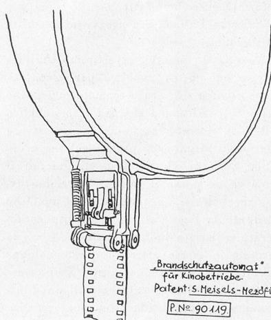
Der «Feuerschutzautomat» funktioniert nun folgendermaßen: An der Oeffnung, durch welche der Filmstreifen die obere Trommel verläßt oder in die untere Trommel einmündet, wird die Vorrichtung angebracht. Diese bildet sodann eine Fortsetzung des Laufkanals, durch welchen der Filmstreifen geht. Die eine Wandung des Automaten ist beweglich und wird durch
