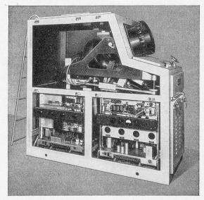
Bild 3. Seitenansicht des Fernseh-Projektors bei geöffneten Wänden.
