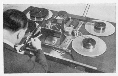
Tonschneidetisch. — Arbeitsvorgang: Synchronanlagen eines getrennten Bild- und Tonbandes. Turieia-Film A.G.
