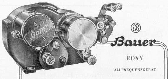
hat vielen Theatern aller Grössen bessere Tonwiedergabe gebracht. Mit dem Anlauf setzt auch der klangreine und lautstarke Ton ein, dank der neuen Starteinrichtung "Starthelf", die Tonverzerrungen verhindert. Der Film wird in einer Rollenbahn vorberuhigt, läuft ohne Gleiten auf Metallteilen sicher, ruhig und geschont auf der rotierenden Tonbahn. — Das Roxy-Gerät hat Schwungmassenausgleich über Reibradgetriebe, Spezial-Mikro-Optik mit einfacher Spaltverstellung und Hochleistungs-Fotozelle.
