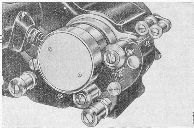
des Schleifenfängers am Bauer-ROXY-Lichttongerät schont den Film. Grosser Durchmesser und grosser Umschlingungswinkel der Tonbahn sorgen für eine gute Mitnahme und Stabilisierung des Films. Nur eine Schraube ist zu lösen, um den ganzen Rollenhalter zum Reinigen abzunehmen. Fragen Sie bitte an bei den Generalvertretern:
