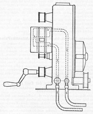
Schema der Wasserkühlung im Werk und Bildfenster
