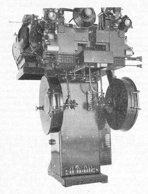
Die neue Philips Blockpost-Anlage stellt in jeder Beziehung eine vollständige Anlage dar. Sie besteht aus Projektor nebst Lampengehäuse, Tonkopf und einem besonderen Traggestell, einem Blockpost (auf dem der Projektor ruht), in welchem alle Verstärker und Gleichrichter untergebracht sind.
