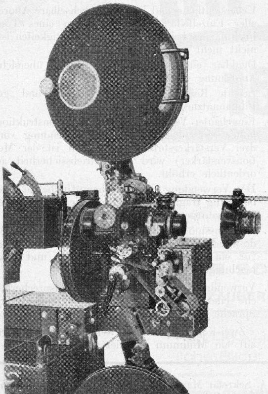
zur Konstanthaltung der Geschwindigkeit eine in ihrer Art einzig dastehende Regelvorrichtung: den patentierten Philips Ticker-Regler. Der Regelyvorgang geht wie folgt vonstatten:
