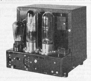
Die Felderregung der Lautsprecher erfolgt durch einen im Fuss des Projektors eingebauten Gleichrichter. Die Schaltung ist so eingerichtet, dass der Abhörlautsprecher in der Kabine nur bei angeschlossenem Gleichrichter eingeschaltet werden kann. Es ist also unmöglich, dass der Operateur vergisst, die Saallautsprecher einzuschalten.
