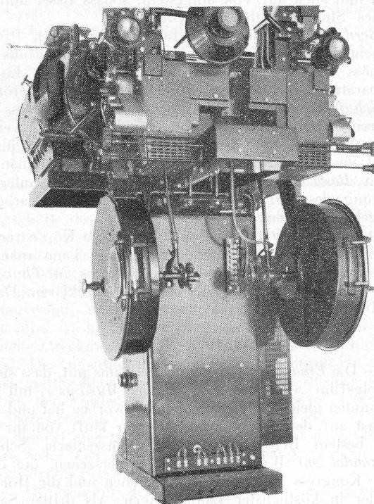
Die neue Philips Blockpost-Anlage stellt in jeder Beziehung eine vollständige Anlage dar. Sie besteht aus Projektor nebst Lampengehäuse, Tonkopf und einem besonderen Traggestell, einem Blockpost (auf dem der Projektor ruht), in welchem alle Verstärker und Gleichrichter untergebracht sind.
