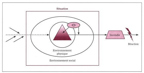
Figure 3: processus menant à un incendie. Divers causes permettent la rencontre des éléments du triangle du feu dans un environnement physique particulier. L'échec du gardien permettra au feu de devenir incendie, une réaction suivra cette transformation.
