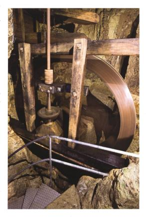
La roue hydraulique du deuxième puits. Par le biais d'un axe vertical et des engrenages, elle actionne le moulin à céréales. Photo Michael Peuckert, 2023
