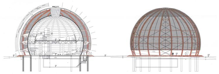
le double du Palais de l'Équilibre, rendu possible par une structure géodésique en tubes d'acier cylindriques.
