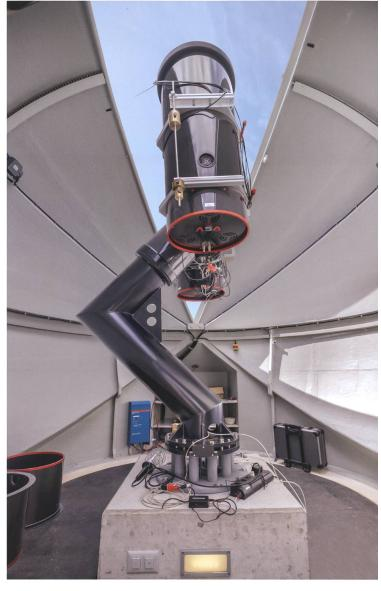
Sternwarte Zimmerwald: Die beiden neuen, futuristisch anmutenden Kuppelbauten loten präzise den Abstand zur bestehenden Anlage aus. Die Stampfbeton-Ummantelung kontrastiert farblich mit den beiden Kuppeln (links oben). Die Teleskope stehen auf einem unabhängigen Sockel, damit die Gebäudeschwingungen die Messungen nicht beeinträchtigen (rechts). Fotos Michael Peuckert
