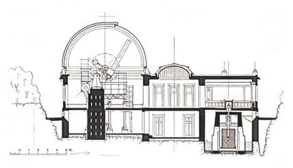
Fig. 10 Coupe longitudinale du Pavillon Hirsch: à gauche, en noir, le large support de la double lunette équatoriale, à droite, le support de la cuve du sismomètre, tous deux fixés à même le rocher. Tiré du Bulletin technique de la Suisse romande 38, n° 21 (1912)
