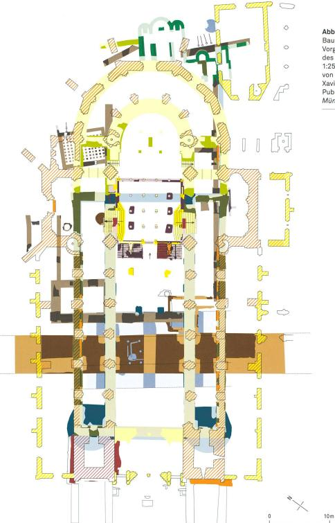
Abb. 15 Synoptischer Bauphasenplan der Vorgängerbauten und des Basler Münsters. 1:250. Planzeichnung von Marco Bernasconi, Xavier Näpfli, für die Publikation Das Basler Münster. 2019. ABBS
