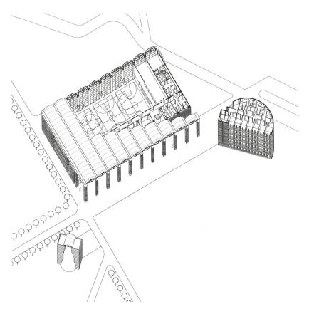
Spaccato assonometrico degli edifici della seconda fase. Nel Gottardo si può apprezzare la permeabilità delle palestre, visibili da tutti gli ambienti al primo piano come da una balconata.
