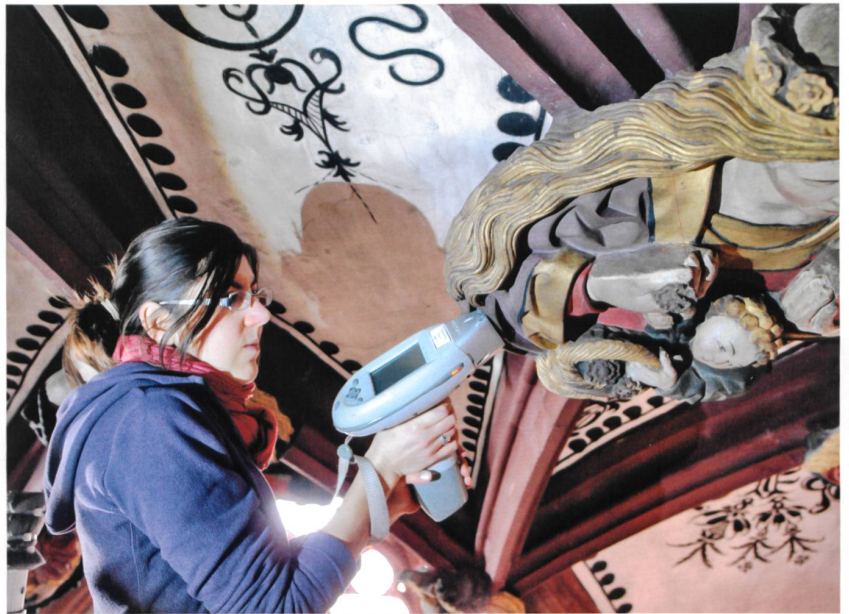
Abb. 7 Berührungsfreie Analyse der Farbfassungen mithilfe der XRF-Spektroskopie (Röntgenfluoreszenzanalyse / X-ray fluorescence spectroscopy) an Stellen, wo nach der detaillierten restauratorischen Befundaufnahme noch spezifische Fragen offen waren. Durch diese Voruntersuchungen konnte die benötigte Zahl an Laborproben im Chorgewölbe sehr klein gehalten werden. Im Bild: Rowena Pasche, Restauratorin der Münsterbauhütte. © Berner Münster-Stiftung
