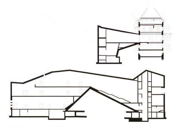
Querschnitt Landesmuseum mit Erweiterungsbau (oben) und Längsschnitt Neubau (unten), Massstab 1:100. Pläne Christ & Gantenbein, Basel Von aussen hat sich mit dem Erweiterungsbau nur das Gesamtensemble verändert – das Gull'sche Bauwerk scheint in seiner Aussenwirkung unangetastet. Inwieweit zeigt sich die Erneuerung der Institution auch in der äusseren Erscheinung des Bauwerks?
