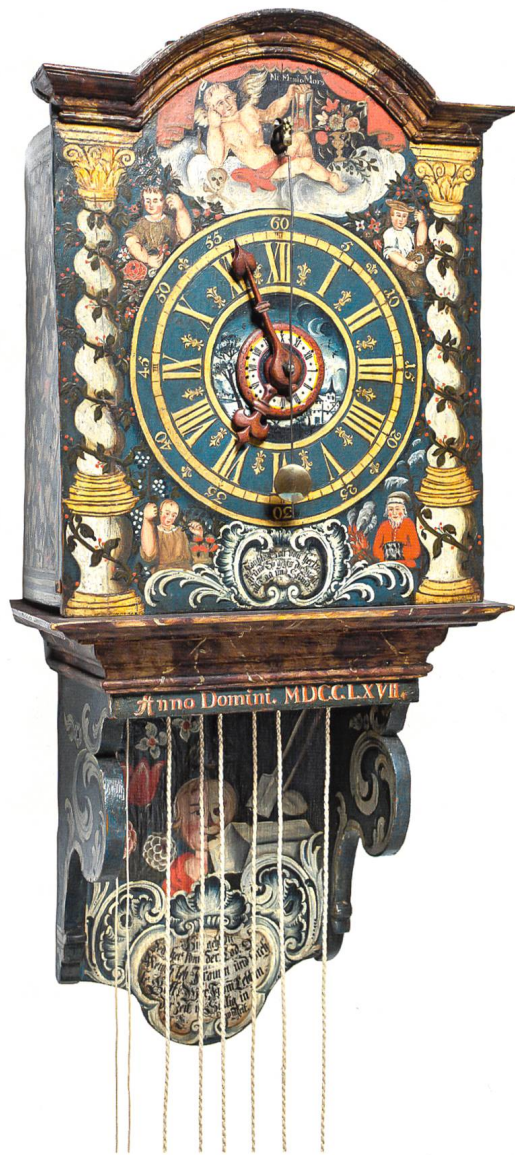
Appenzeller Holzräderuhr. Teufen, 1767. Sign. Emanuel Brugger, Teufen AR. 1767. Gehwerk mit Spindelgang, Stundenschlagwerk, Wecker, beide Werke auffallend grosse Holzräder mit eingesetzten Eisenzähnen, Bemalung mit Jahreszeiten, Symbolen der Vergänglichkeit und Sinnsprüchen. Inv. 4. Fotos Michael Peuckert
