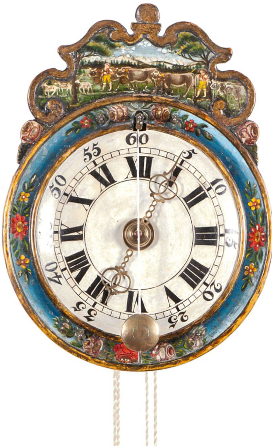
Kleine Appenzeller Holzrädenuhr. Appenzell, um 1790. Gehwerk mit Spindelgang und Stundenschlagwerk. Legat Rosa Kellenberger-Zürcher. Inv. 346. Als Gangarten gibt es bei den Appenzeller Uhren von der Waag über die Spindelhemmung mit kurzem Vorderpendel bis zum Hakengang mit langem Pendel alle drei gängigen Hemmungsvarianten des 18. und auch 19. Jahrhunderts. Oft wird Zwetschgen- oder Birnbaumholz für das Räderwerk verwendet. Typisch für diese Gegend sind die charakteristischen Prägungen seitlich am Gestell. Foto Michael Peuckert
