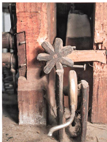
Holzräderuhr mit Figuren- automaten («Mülleruhr»). Neuenburg, 1752. Gehwerk mit Spindelgang, 4-Viertel- und Stundenschlagwerk, zwei Schlagfiguren und einem Flötenspieler. Inv. 376. Fotos Uhrensammlung Kellenberger
