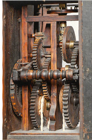
St. Galler Holzräderuhr. St. Gallen, 1784. Sign. Nr. 7 Weyerman à St. Gallen 1784. Niklaus Weyermann (1751–1829). Gehwerk mit Spindelgang, Stunden- schlagwerk. Inv. 11. Fotos Michael Peuckert
