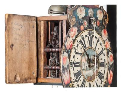
Appenzeller Holzräderuhr. Appenzell, 1768. Sign. 17 Joseph Guttman 68. Gehwerk mit Spindelgang, 4-Viertel- und Stundenschlagwerk. Inv. 3. Ein Merkmal im Werk einfacher Uhren von Guttmann lässt doch eher auf den Uhrmacher schliessen. Diese haben eine Eigenheit am Hebel, der die Hammerwelle für das Schlagen bedient, die als «Guttmann-Haarnadel» bezeichnet wird. Foto Michael Peuckert
