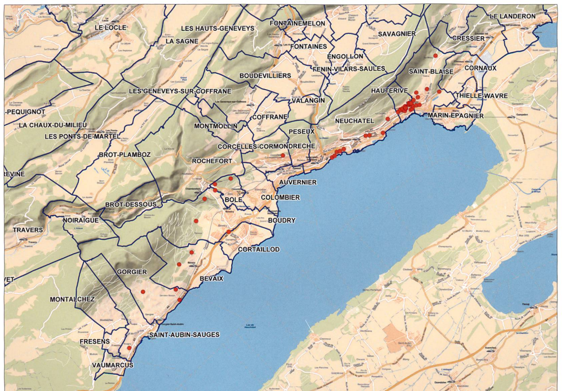
Fig. 1 La carte des carrières de Pierre jaune de Neuchâtel, établie par comparaison entre les sources historiques et les affleurements géologiques, souligne que les meilleurs bancs se situent dans les alentours d'Hauterive. CS Raster Tele Atlas © CARTOSPHERE, SITN et OPAN
