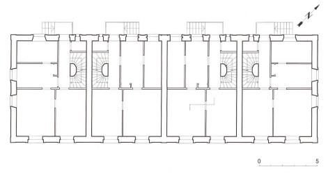
**Plan du rez-de-chaussée** de la rangée orientale des logements ouvriers de 1888–1889 (restitution de l'état avant la modernisation de 1987, dessin A.-L. Python-Lecoultre sur la base des plans Cuerel Architectes)
