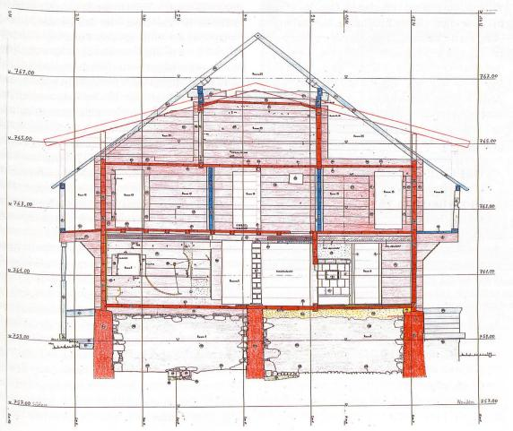
Abb.3 Haus Unterblacki, Schnitt Nord-Süd, Räume im Vorderhaus: originale Bausubstanz von 1510 beziehungsweise Rekonstruktion (rot). Umbauten des 16.–18. Jahrhunderts (gelb). Umbauten und Erweiterung Ende des 18. Jahrhunderts (blau). Natürlich gewachsener Boden (grün)
