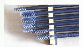
Detail aus dem Werkzeugkoffer: handbetriebene Hohlbohren
