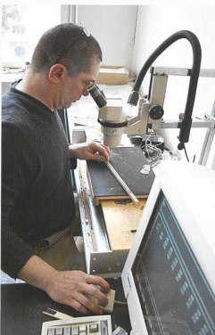
Im Labor: Messung der Jahrringbreiten
