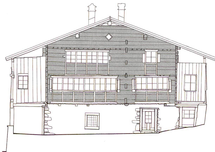
Schwyz, Haus Bethlehem, Ostfassade (Grauraster = originale Bauteile). (Repro, S. 112)
