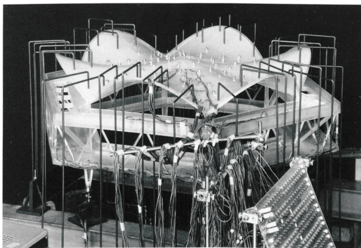
Heinz Hossdorf, Salle de lecture de la bibliothèque universitaire de Bâle (1962–64), modèle réduit à l'échelle 1:20 en résine acrylique pour des mesures de précision sur l'élasticité de la structure. (tiré du livre, p. 86)
