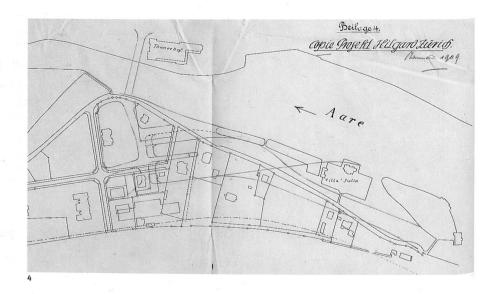
der seitlich des geplanten Bahnhofplatzes endet. Da kein zentraler Schiffssteg geplant war, konnten nur zwei Schiffe gleichzeitig unabhängig voneinander bedient werden. Vor der Oberen Schleuse waren die von Gelpke empfohlenen Abwehrpfähle vorgesehen, «um ein Aufprallen eines Schiffes, sei es bei unrichtiger Manövrierung, Versagen der Steuerung, oder durch einen Defekt zu vermeiden.» 15
