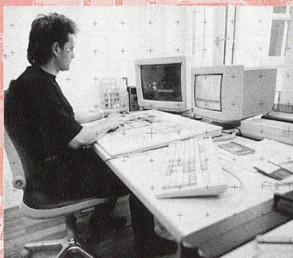
CAD-Arbeitsplatz mit photogrammetrischem Auswertesystem
