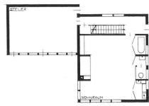
Hausteile zutage. Die Funktionen Wohnen und Arbeiten sind durch den Erschliessungsbereich, durch das rückwärtige Treppenhaus, das den Zugang zu den Wohnungen und zum Atelier gewährleistet, und durch das Flachdach über dem Ateliertrakt, das gleichzeitig als Terrasse der Wohnung im ersten Obergeschoss dient, miteinander verschränkt. Die gesamte Konzeption des Hauses baut auf der Grundlage von Primärvolumen auf, die gegenseitig überzeugend aufeinander bezogen sind.
