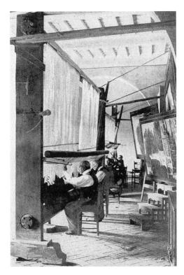
2 Arazzieri al lavoro su telai ad alto liccio nella manifattura romana di San Michele a Ripa, inizio del XX secolo. – Sulla destra è riconoscibile il quadromodello che l'arazziere sta riproducendo su un telaio ad alto liccio.
