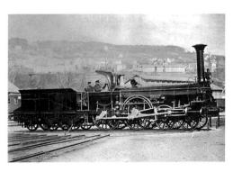
Übertragung der Kraft erfolgte mit Stangen und Kurbeltrieben. Brennmaterial und Wasservorrat wurden entweder auf der Lokomotive selbst (z. B. Abb. 7) oder in einem speziellen Anhänger, dem Tender geladen (z. B. Abb. 9). In der Regel wurden pro Tonne Kohle etwa 2500 Liter Wasser mitgeführt.
