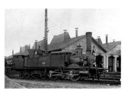
Dampfmaschinen zwecklos sind, wurde die erzielbare Geschwindigkeit über den Durchmesser der Räder gewählt. Schnellzuglokomotiven hatten grosse Räder von gegen zwei Metern Durchmesser (z. B. Abb. 1), Rangierlokomotiven solche von weniger als einem Meter (z. B. Abb. 10).
