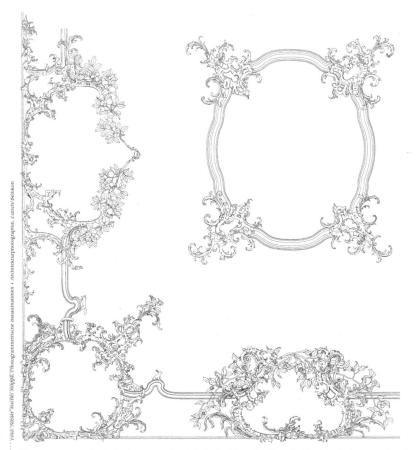
Photogrammetrische Aufnahme einer Stuckdecke im Haus Rechberg in Zürich. Dokumentation für die Denkmalpflege des Kantons Zürich.
