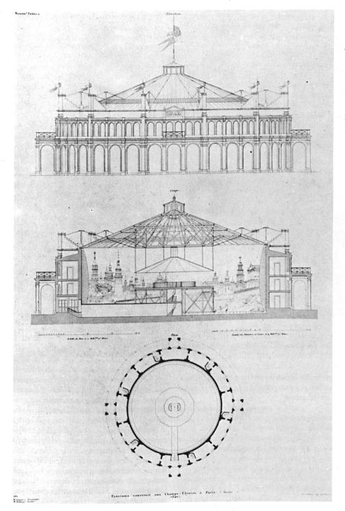
1 Parigi, Champs-Elysées, Gran Carré, rotonda del Panorama del colonnello Ch. Langlois: alzato, sezione e pianta, Jakob Ignaz Hittorff, 1840. Incisione, 49,2×32,1 cm, da un disegno di Hittorff (Wallraff-Richartz-Museum, Colonia). – La volta conica è sorretta mediante il sistema di sospensione dei ponti con l'impiego di tiranti in ferro. Nella sezione sono visibili la piattaforma, accessibile da una scala a chiocciola, e il «velum».
