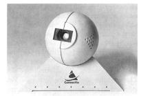
QuickCam ist eine Videokamera in der Grösse einer Billardkugel. Auf dem mitgelieferten Ständer lässt sie sich bequem auf alle Seiten richten. Sie kann auch in der Hand geführt oder auf ein Stativ aufgeschraubt werden. Alles, was vor die Linse kommt, erscheint sogleich auf dem Bildschirm.
