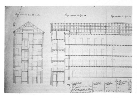
6 A. Pichard, Detail eines Schnittes durch einen der fünf Flügel, 1822, Staatsarchiv Bern. – Die Aufsichtsräume waren gegenüber denjenigen der Häftlinge um halbe Geschosshöhe versetzt, was das gleichseitige Überwachen zweier Korridore ermöglicht hätte.
