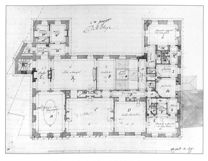
8 Johann Ulrich Büchel, 1753-1792, Haus «Zum Kirschgarten», Grundriss der 2. Etage (o. D., vor 1775), Staatsarchiv Basel. - Der Plan entspricht der ausgeführten Variante. Legende zur Numerierung (vom Verf. eingefügt aufgrund der Bezeichnung in anderen Planvarianten): 1) Antichambre; 2) Chambre à coucher de Madame; 3) Chambre à coucher de Monsieur; 4) Cabinet (dasjenige an der linken Fassadenseite trägt heute die Bezeichnung «Rosenboudoir»); 5) Garderobe.
