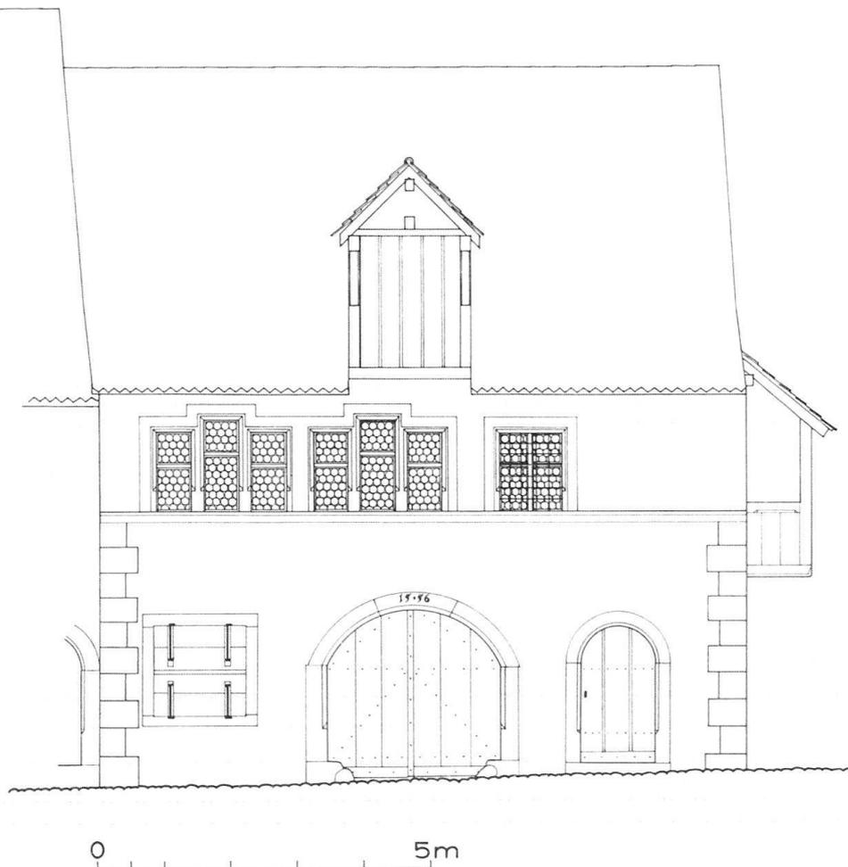
Abb. 4. Zurzach, Haus «zum Elefanten» Westfassade, Rekonstruktion I.
