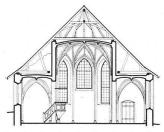
1 Querschnitt einer Stufenhalle mit Satteldach (La Sagne). Das Mittelschiff ist überhöht, besitzt jedoch keine eigene Befensterung.
