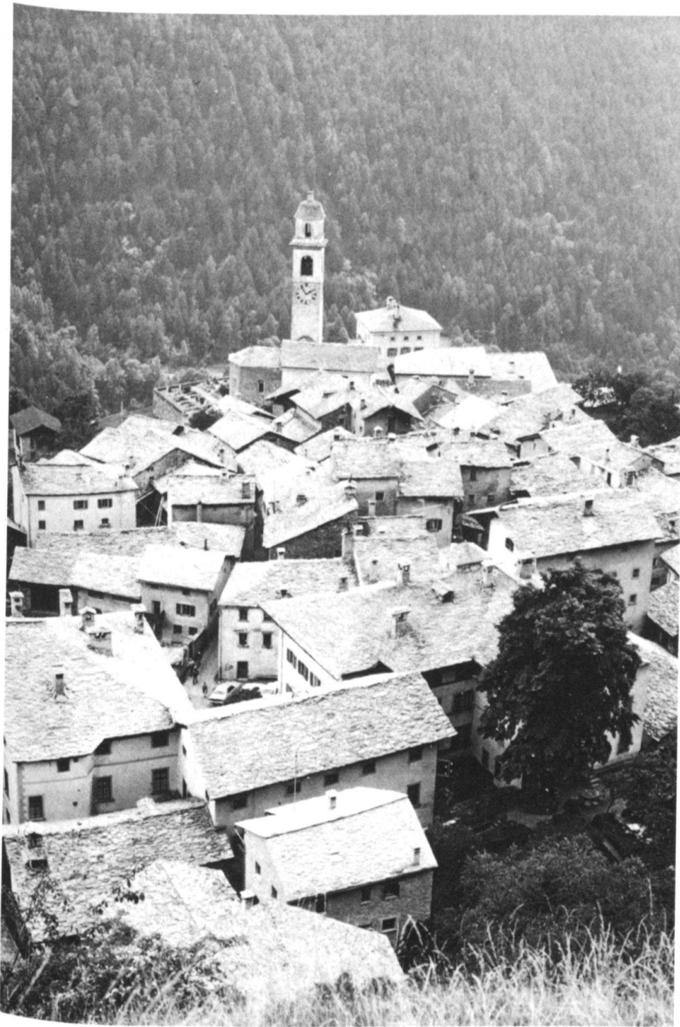
3 Soglio von Norden. Einheitliche Dachlandschaft, mit Quarzitplatten gedeckt.
