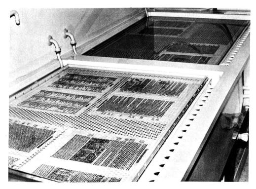
3 Teil einer speziell konstruierten Wannenauflage zum Auswaschen von Restchemikalien im Fliesswasser. Zu- und Abfluss sind so angelegt, dass jedes Blatt mit der gleichen Menge Wasser umspült wird. Dauer der Wässerung: ca. vier Stunden.
