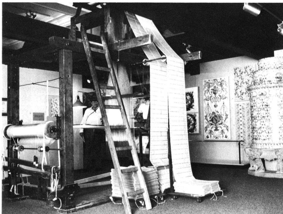
1 Métier à tisser à mécanique Jacquard, provenant des ateliers Prelle à Lyon, et desservi en permanence dans le cadre des somptueuses soieries qu'il est seul capable de produire encore.
