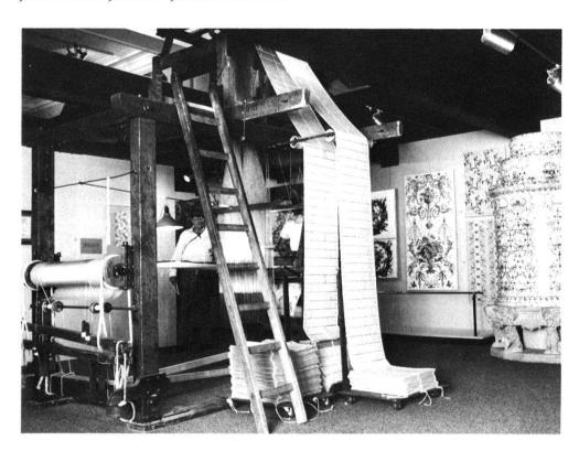
1 Métier à tisser à mécanique Jacquard, provenant des ateliers Prelle à Lyon, et desservi en permanence dans le cadre des somptueuses soieries qu'il est seul capable de produire encore.
