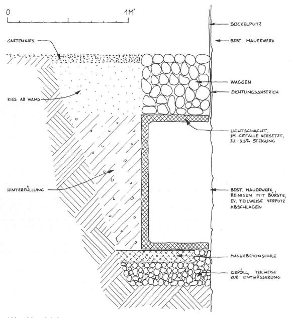
Abb. 1. Mauerbelüftung
