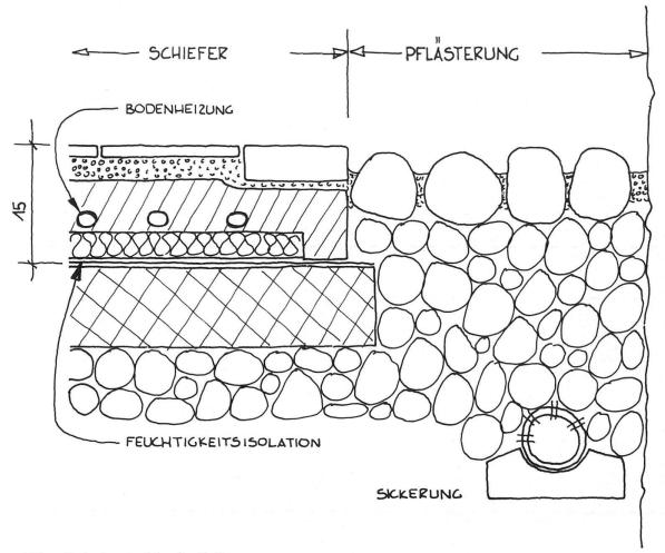
Abb. 2. Bodenkonstruktion im Keller
