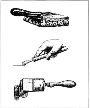
Abb. 2 und 3. Runde Streichbürste mit kurzem Stiel, Schablonierbürste, zwei Leimfarbentupfer, der kleine zum Tupfen der Ecken. – Schwammtupfer mit auswechselbaren Schwämmen, Linienzieher, Porenwalze mit Holzrolle und Modler
