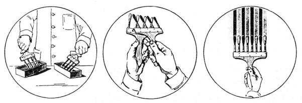
Abb. 4. Zweifarben-Durchzieher ermöglichen Zweifarbenwirkung in einem Arbeitsgang
