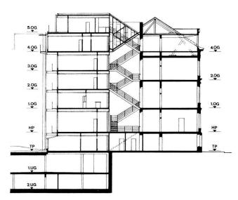
Abb. 9 und 10. Amthaus, Grundriss des Hochparterres und Schnitt (von B nach B) nach Restaurierung und Bau des Ergänzungsflügels anstelle des Gefängnis-Anbaus, der ebenfalls bereits selbständige Stockwerkhöhen aufgewiesen hatte. Die beibehaltenen Teile des Gründungsbaus sind an der Mauerstärke ohne Schwierigkeit zu erkennen
