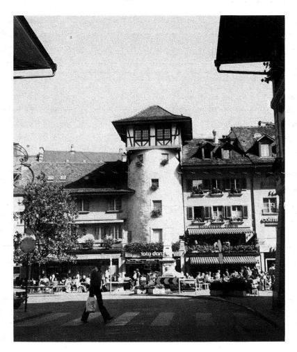
Abb. 5. Holländerturm am Waisenhausplatz. Halbrunder Wehrturm im Verlauf der äusseren Ringmauer des dritten Westgürtels von 1256. Aussen verputzte, massive Turmschale, die Flanken in Sichtquaderwerk. Der Zinnenkranz ist seit dem Umbau zum Wohnhaus im 16. Jahrhundert durch Fenster markiert. Die in Riegkonstruktion aufgesetzte Turmstube des 17. Jahrhunderts diente den ehemaligen Offizieren in holländischen Diensten als Versammlungsund Rauchsalon, daher der Name
