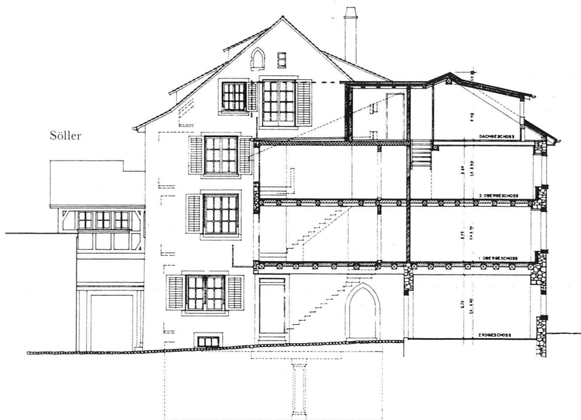
Abb. 14. Schnitt- und Ansichtsplan (Massstab 1:200) mit markiertem Keller (Stud), Söller, neuer Giebelwand mit Fenster und Dachterrässli
