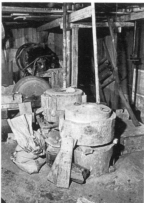
Dällikon. Hafnerei Fritz Gisler. Links: Hafner Fritz Gisler beim Bereitstellen des Lehms zum Kneten mit Händen und Füßen. – Rechts: Glasurherstellung: Im Vordergrund zwei altertümliche Glasurmühlen für Handbetrieb, eine davon abgeändert für Betrieb mit Wasserkraft. Beide wurden aus früheren Hafnerwerkstätten übernommen (L. Gollob, Dietikon; K. Breiter, Kilchberg). Im Hintergrund eine Kugel- oder Trommelmühle aus der Jahrhundertwende.
