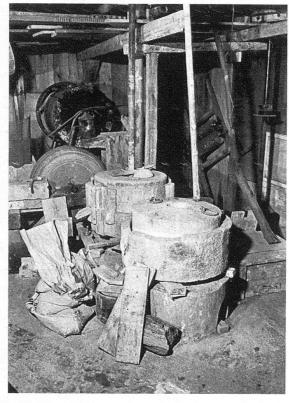
Dällikon. Hafnerei Fritz Gisler. Links: Hafner Fritz Gisler beim Bereitstellen des Lehms zum Kneten mit Händen und Füssen. – Rechts: Glasurherstellung: Im Vordergrund zwei altertümliche Glasurmühlen für Handbetrieb, eine davon abgeändert für Betrieb mit Wasserkraft. Beide wurden aus früheren Hafnerwerkstätten übernommen (L. Gollob, Dietikon; K. Breiter, Kilchberg). Im Hintergrund eine Kugel- oder Trommelmühle aus der Jahrhundertwende.
