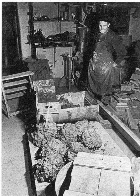
Dällikon. Hafnerei Fritz Gisler. Links: Hafner Fritz Gisler beim Bereitstellen des Lehms zum Kneten mit Händen und Füßen. – Rechts: Glasurherstellung: Im Vordergrund zwei altertümliche Glasurmühlen für Handbetrieb, eine davon abgeändert für Betrieb mit Wasserkraft. Beide wurden aus früheren Hafnerwerkstätten übernommen (L. Gollob, Dietikon; K. Breiter, Kilchberg). Im Hintergrund eine Kugel- oder Trommelmühle aus der Jahrhundertwende.
