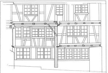
Deckenbalkenlage ist so in die Mauer eingelassen, dass wir vermuten, es hätte schon damals ein weiteres Geschoss darüber gelegen. Genau dort fanden wir Reste einer Ständerwand mit symmetrischen Fussbändern. Letztere hatte man zwar beim Einbau eines neuen Fachwerks weggeschlagen, die Paare von Löchern für Holznägel zeigten jedoch selbst auf der Innenseite die ehemalige Anordnung genau an.
