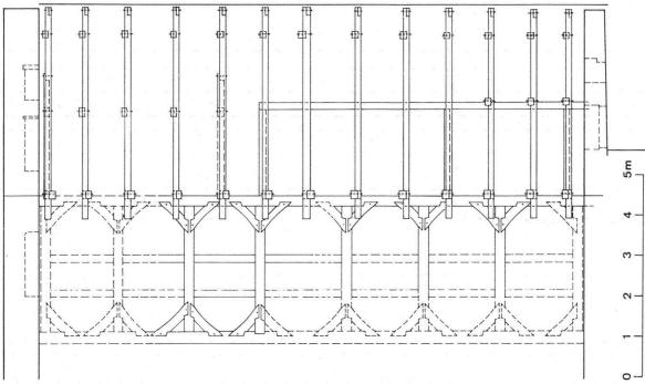
Abb. 3. Zürich. Weite Gasse 11. Ständerwand des 3. Obergeschosses und Dachstuhl während der Untersuchungen zur Zeit des Abbruchs. Die Holzkonstruktion stammt möglicherweise aus dem 14. Jh. – Pläne. Oben: Querschnitt und Aussicht des 3. Obergeschosses (teilweise rekonstruiert); unten: Längsschnitt und Nordwestfassade
