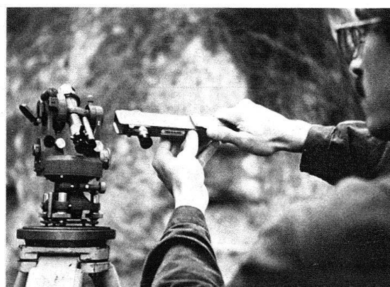
Zwei Spezialisten des Instituts: Dr. phil. II Andreas Arnold bei Materialuntersuchungen im Labor; der Kulturingenieur Rudolf Glutz bei Vermessungsarbeiten, die meist mit einem Winkelmessgerät (Bussolentheodolit, links) ausgeführt werden; topographische Kartierungen in Felsen erfordern ab und zu auch ungewöhnliche Methoden und Geräte (Kurzdistanz-Telemeter für unzugängliche Punkte, rechts)
